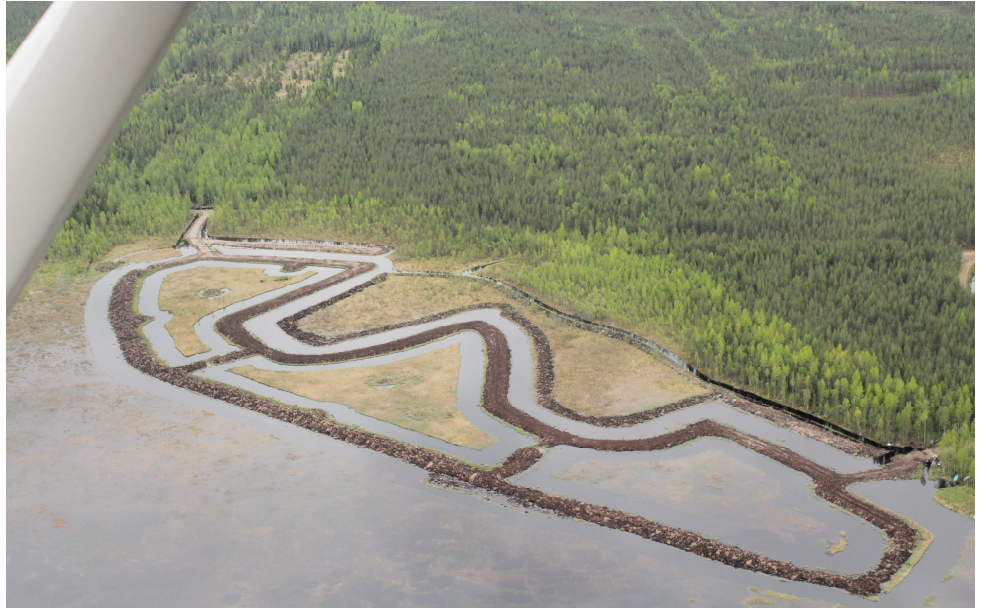
Vanhanmajan kosteikko 2.6.2014, kun ympäröivän Kortteisen tekojärven pinta on vielä korkealla. Kosteikolla on 3 osa-aluetta, joista läntisimmän (kuvassa oikealla) vedenpinta on säädetty patolaitteella korkeimmalle tasolle. Kuva Juha Siekkinen.
